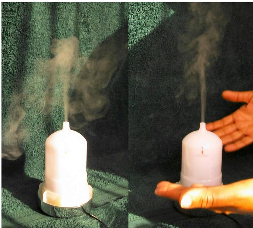
Figure 2.7: Mettre en marche le diffuseur. On voit que le brouillard retombe rapidement.
