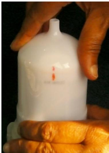
Figure 2.4: Oter le capot protecteur et le couvercle pour accéder au réservoir
