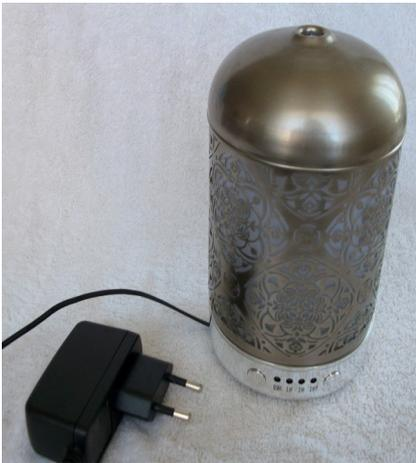
Figure 2.1: Diffuseur d'huiles essentielles piézo-électrique
