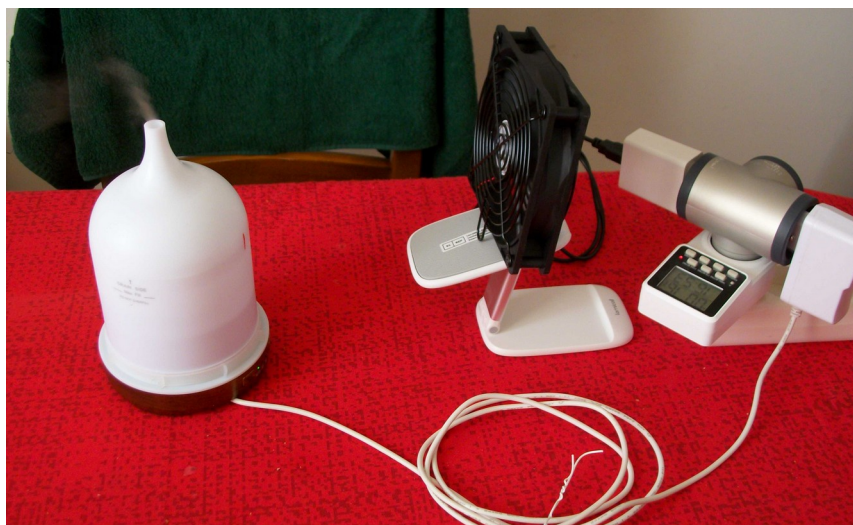
Figure 47: Montage avec ventilateur et programmeur pour personne à mobilité réduite. Le ventilateur et le diffuseur sont branchés sur le programmeur via la multiprise
